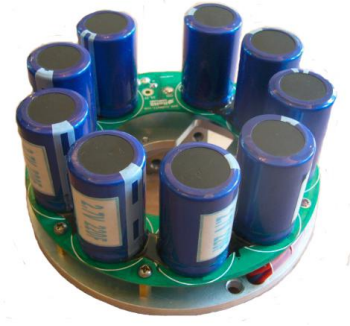
图10: 超级电容板 (VA3301/3303)
